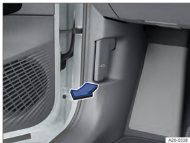
Рис. 173 В пространстве для ног со стороны водителя: рычаг открывания капота (принципиальная схема).
