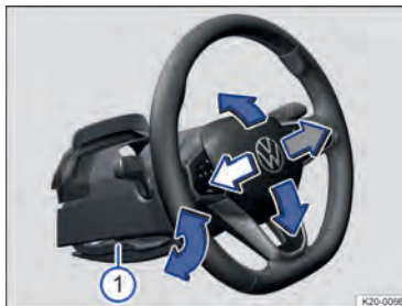
Рис. 72 Под рулевым колесом в облицовке рулевой колонки: рычаг механической регулировки положения рулевого колеса.
