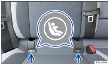
Рис. 43 Маркировка, обозначающая точки крепления ISOFIX для детских кресел на сиденьях многоместного сиденья.
