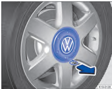
Рис. 187 Снятие обшивки центрального колеса путем стаскивать.
