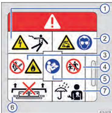
Рис. 141 Предупреждающий знак о высоковольтной батарее.
