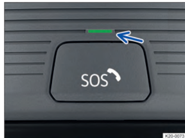
Рис. 51 В потолочной консоли: управление по закону необходимая система аварийного вызова eCall (за крышкой кнопки).
