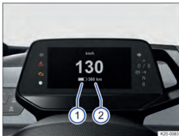
Рис. 11В цифровой комбинации приборов: уровень заряда высоковольтной батареи и транспортное средство 1 диапазон 2
