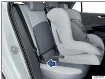
Рис. 46 Иллюстрация: установка детского сиденья с помощью кронштейнов крепления.
