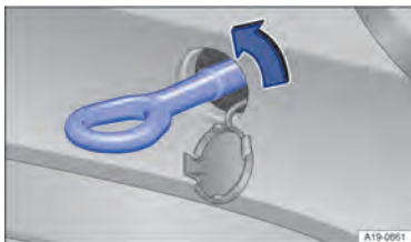
Рис. 172 В заднем бампере справа: ввинчивание буксирной проушины; ввинчивание буксирной проушины.
