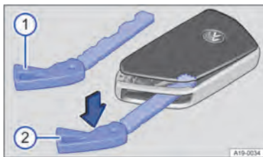
Рис. 55 Ключ автомобиля: открытие крышки аккумуляторного отсека.
