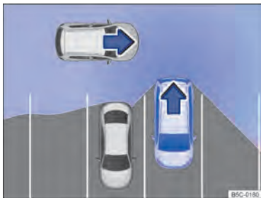
Рис. 119 Иллюстрация предупреждения о движении сзади: контролируемая зона вокруг автомобиля, покидающего парковочное место.
