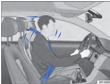
Рис. 25 Водитель удерживается правильно пристегнутым ремнем безопасности во время резкого торможения.
