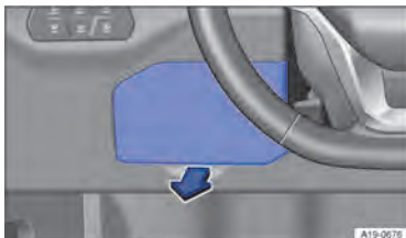
Рис. 162 Автомобиль с левосторонним управлением: крышка блока предохранителей в приборной панели со стороны водителя
