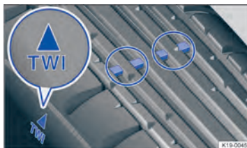
Рис. 185 Протектор шины: индикаторы износа протектора.
