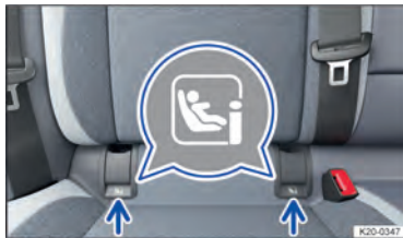
Рис. 44 Маркировка, идентифицирующая анкер i-Size-возрастные баллы для детских кресел на сиденьях заднего многоместного сиденья.
