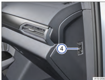
Рис. 9 При открытой двери переднего пассажира (автомобили с левосторонним управлением); переключатель с ключом на приборной панели (зеркальный для автомобилей с правосторонним управлением).
