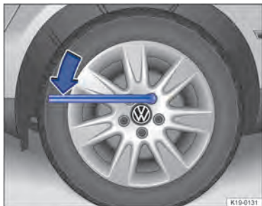
Рис. 191 Замена колеса: ослабление колесных болтов.
