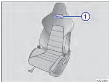
Рис. 49 В спинке спортивного сиденья Top со стороны пассажира: отверстие для верхнего троса (схематическое изображение).
