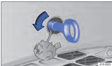
Рис. 170В переднем бампере справа: вкручивание буксирной проушины.
