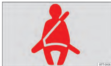
Рис. 19 На дисплее комбинации приборов: контрольная лампа.
