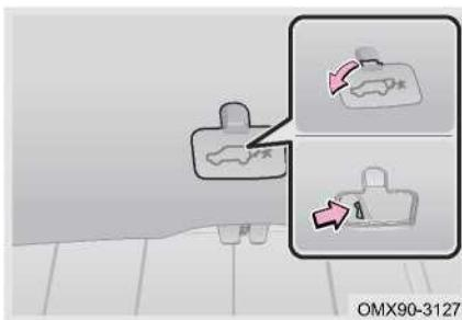
Задняя дверь не может быть открыта, когда батарея разряжена или в подобных условиях. В этом случае заднюю дверь можно открыть с помощью аварийного выключателя задней двери (остановите автомобиль как можно плавнее).
