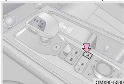
Переключатель системы спуска с холма расположен на вспомогательный фасционной консоли.
