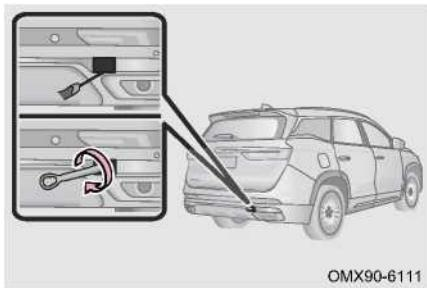
Шаг 2: Используйте отвертку с обмотанным лентой наконечником, чтобы снять крышку отверстия задней буксирной проушины.
