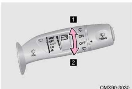
Включите питание автомобиля в режим ON, переместите переключатель стеклоочистителя: MIST: 1 цикл очистки на низкой скорости.
