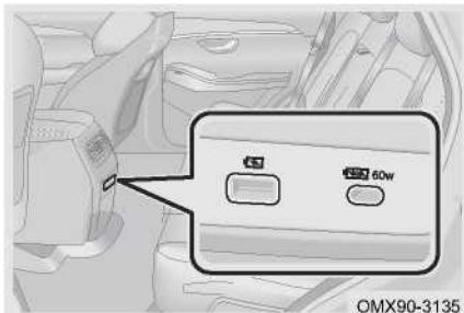
Задний порт USB расположен под задним воздуховодом. Он может обеспечить функцию зарядки для внешних USB-устройств. Интерфейс типа А слева, максимальная мощность 10 Вт. Интерфейс type-C справа, максимальная мощность 60 Вт.
