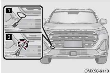
Шаг 2: Используйте отвертку с обмотанным лентой наконечником, чтобы снять крышку отверстия передней буксирной проушины.
