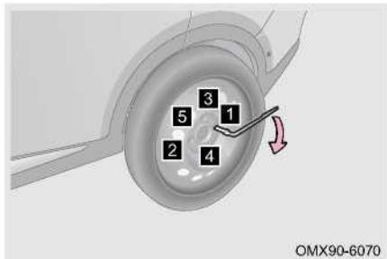
Шаг 4: Используя ключ для колесных болтов, затяните каждый колесный болт 2 или 3 раза в последовательности, показанной на рисунке. (Момент затяжки:  $130 \pm 10 \text{ Н}\cdot\text{м}$ )
