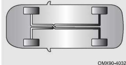
Тормозная система использует двухконтурную тормозную систему X-типа; Система представляет собой гидравлическую систему с двумя независимыми подсистемами. Если одна из подсистем выходит из строя, другая система все еще может выполнять функцию торможения. Однако усилие нажатия на педаль тормоза будет больше обычного, как и тормозной путь, а индикатор неисправности тормозной системы останется включенным.
