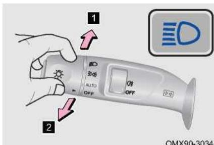
**1** При включении ближнего света нажмите комбинированный переключатель фар от себя, чтобы включить дальний свет. Снова отодвиньте переключатель от себя или потяните переключатель в исходное положение, чтобы выключить дальний свет.
