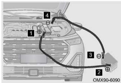
Шаг 2: Подсоедините кабели в соответствии со следующими шагами (для автомобилей с облицовкой моторного отсека сначала необходимо снять защитную крышку аккумуляторной батареи):
