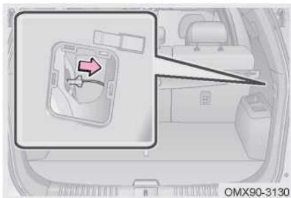
В некоторых случаях крышку топливного бака невозможно открыть с помощью ручки крышки топливного бака. В это время можно использовать аварийный трос, чтобы открыть крышку топливного бака.
