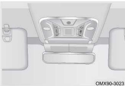
Интенсивность света автомобиля сзади определяется датчиком на зеркале заднего вида и автоматически уменьшает отражение.
