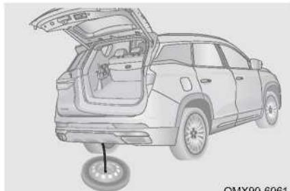
Шаг 4: Опустите стальной трос подъемного механизма запасного колеса. Снимите опорную пластину на конце подъемного механизма и запасное колесо, когда запасное колесо коснется земли.
