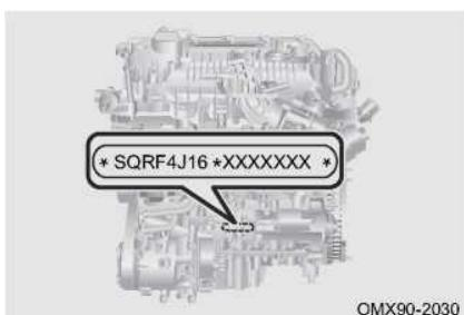
Номер двигателя указан на блоке цилиндров.
