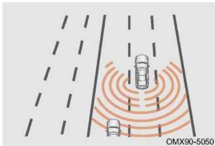
Когда рычаг переключения передач находится в положении D и скорость автомобиля выше 60 km/h при включенной системе BSD, включите левый/правый сигнал поворота, чтобы активировать систему BSD. Когда скорость автомобиля ниже 55 km/h, выйдите из BSD.
