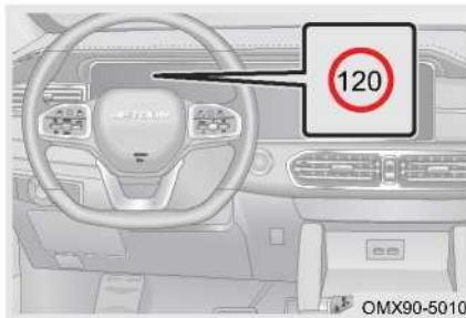
После распознавания информации о знаке ограничения скорости на дороге впереди на приборной панели отображается значок "120", который мигает три раза. При превышении скорости на 10 % индикатор «120» на приборной панели становится красным в сопровождении звуковой сигнализации.
