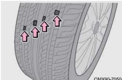
Проверьте протектор шины по следу износа. Когда износ протектора достигает своего предела, протектор будет находиться в той же плоскости, что и полоса износа. Если возникает такое состояние, это указывает на то, что производительность и безопасность шины серьезно снижаются, и необходима ее замена.
