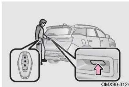
Способ 1: при разблокированном центральном замке нажмите кнопку открывания двери багажного отделения, дверь багажного отделения с двигателем откроется/закроется.
