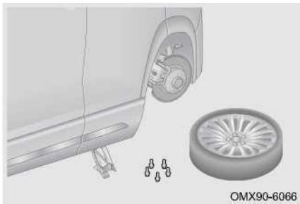
**Шаг 5:** Снимите все колесные болты с помощью ключа для колесных болтов и снимите спущенную шину.
