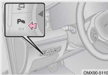
При нажатии выключателя парковочного радара загорается индикатор выключателя парковочного радара, включается передний радар. Нажмите еще раз, индикатор погаснет, передний радар отключится.
