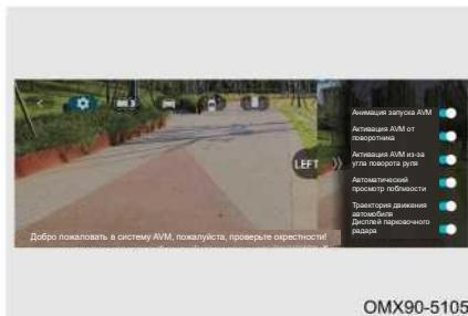
На экране настроек можно включить/выключить начальный экран panoramicного обзора, активировать монитор panoramicного обзора с помощью указателя поворота, активировать угол поворота рулевого колеса, автоматическое масштабирование, отображение направляющих полос, отображение парковочного радара и т. д.
