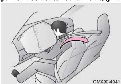
В случае серьезного лобового столкновения подушка безопасности водителя, подушка безопасности переднего пассажира работают вместе с ремнем безопасности, чтобы помочь уменьшить травмы головы или груди водителя и переднего пассажира, вызванные ударом о внутренние компоненты (подушка безопасности переднего пассажира может быть активирована, даже если на пассажирском сиденье нет человека).
